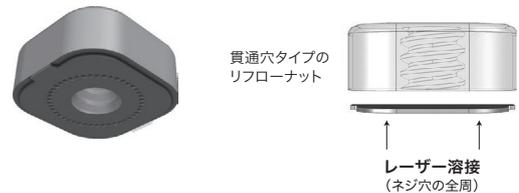
レーザー溶接リフローナットは、超低背 (0.8mm~2.0mm) の非貫通穴タイプでも不完全ネジ部がないため、ネジ山数を多く確保できます。
